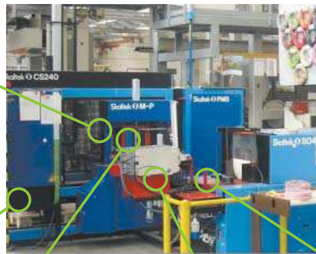
8: La palette complète est alors filmée avant d'être envoyée à l'expédition Das volle Palett wird eingeschumpft und in die Spedition geliefert
