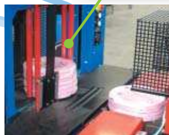
6: Une pile de 2 à 5 couronnes est ensuite formée puis attachée Einzelne Ringe werden zu Stapel von 2 bis 5 Ringen abgebunden
