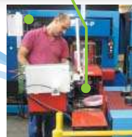
5: Chaque couronne est étiquetée automatiquement Jeder Ring wird automatisch etikettiert
